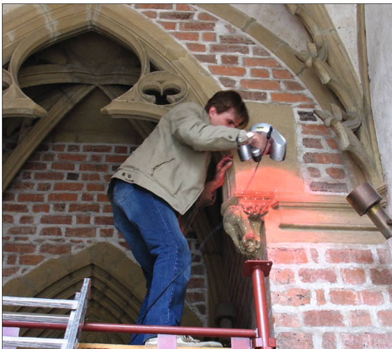
Obr. 5: 3D skenování ručním skenerem reprezentuje v současnosti asi nejpodrobnější a nejpresnější možnou dokumentační metodu architektonického a uměleckého detailu (Hradec Králové, kostel sv. Ducha, královská předsíň; foto F. R. Václavík, 2007).
