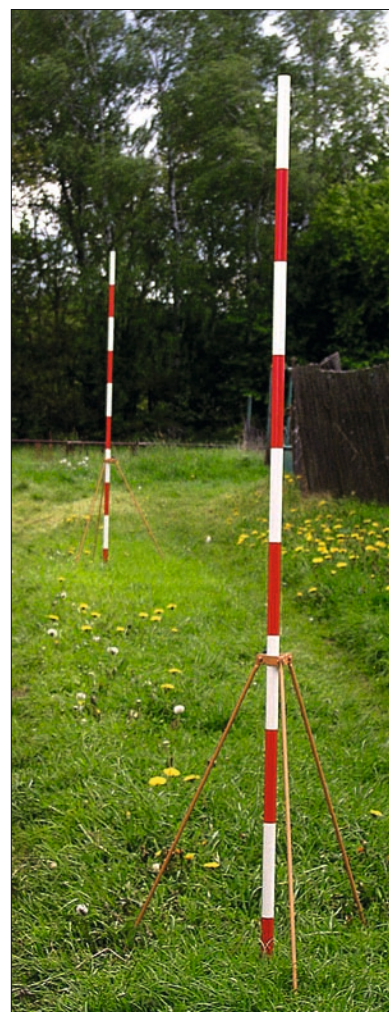
Obr. 43: Výtyčky neboli trasírky se stojánky slouží především k signalizaci měřických bodů při zaměřování polygonálních pořadů a při měření podrobných bodů kolmicovou metodou. S výhodou se ale užívají také jako okládané měřtko u měřických snímků archeologických sond (foto J. Veselý, 2014).
