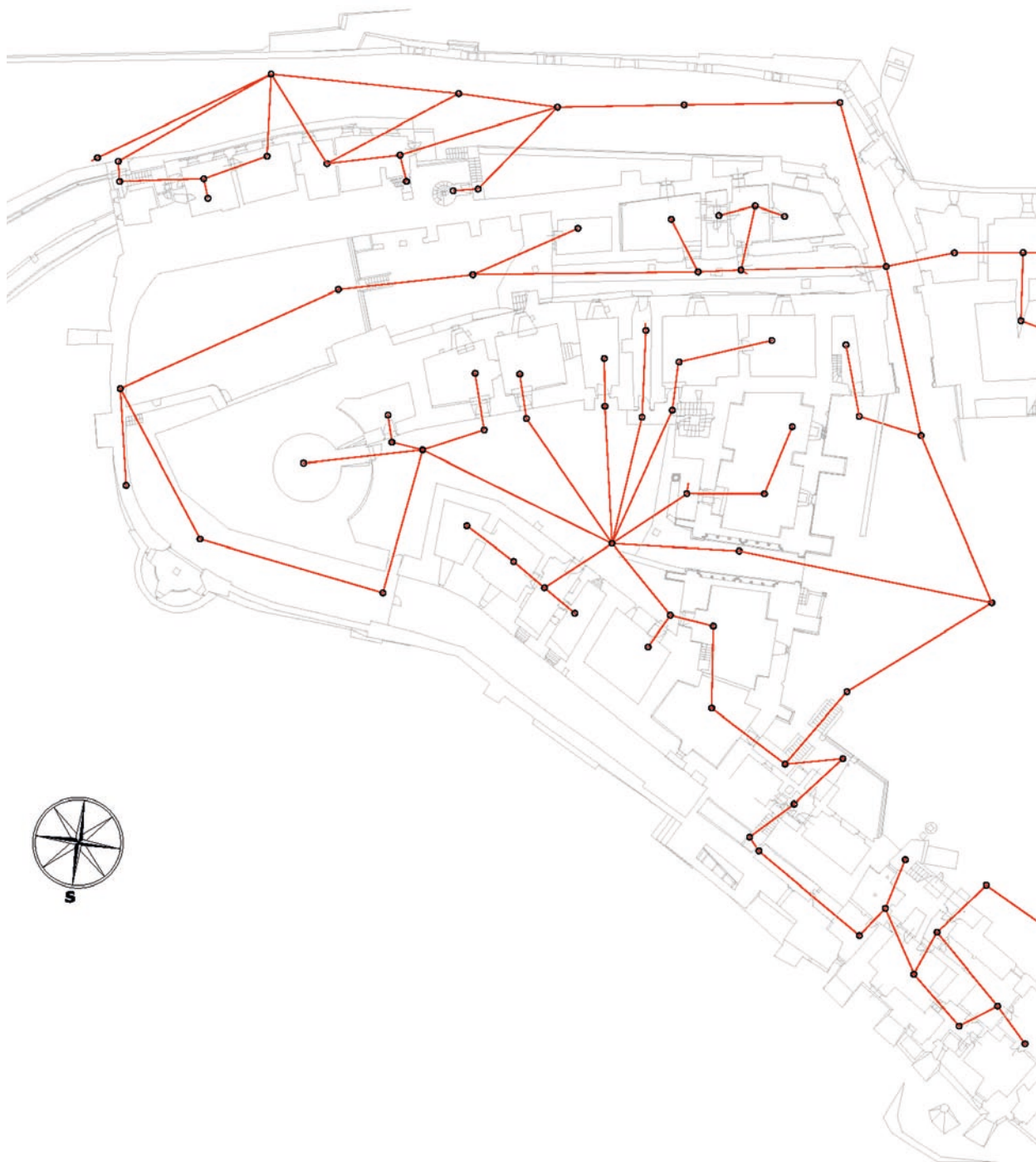
Obr. 47: Zoláště u složitých a rozsáhlých objektů je rozvržení základní měřické sítě, tedy polygonového pořadu, velmi náročné. Vrcholy pořadu by měly být rozmístěny pravidelně a tak, aby každý důležitý podrobný bod byl viditelný nejméně z jednoho vrcholu. Volných rájónů má být co nejméně. Dosáhnout optimální vzájemné viditelnosti stanovisek a vyvarovat se příliš strmých záměr i nevhodných úhlů může být ve stísněných prostorech historické architektury neřešitelným úkolem. Část základní měřické struktury (Křivooklát – okres Rakovník, horní hrad, na základě zaměření ÚGaK z roku 1965; upravil J. Veselý, 2014).
