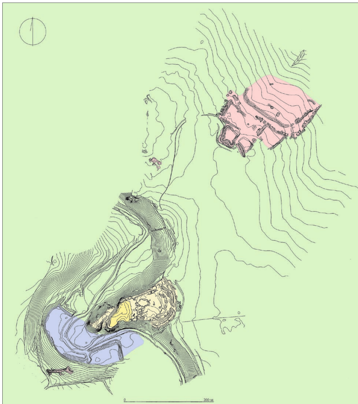
Obr. 77: Vrsteonicoý plán hradu a jeho okolí s relikty obléhacího tábora s intervalem vrsteonic po 1 m představuje dobrý příklad integrace několika různých měření do jednoho výstupu. Základním prvkem je plán vyhotovený z leteckého fotogrammetrického snímkování (firma ARGUS GEO SYSTÉM, s. r. o., úprava dat P. Hlavenka). Do něj byla pomocí identických ulicovacích bodů integrována pozemní geodetická měření (M. Červenka, M. Sýkora, J. Šály), zejména pak hůře viditelné partie pod jehličnany a v tmavém údolí řeky Vrchlice. Posledním krokem je zaměření reliktní obléhacího tábora realizované P. Koscelníkem a kol. (hrad Sion – okres Kutná Hora; zaměření 2011–2013, celková úprava M. Sýkora, 2013).
