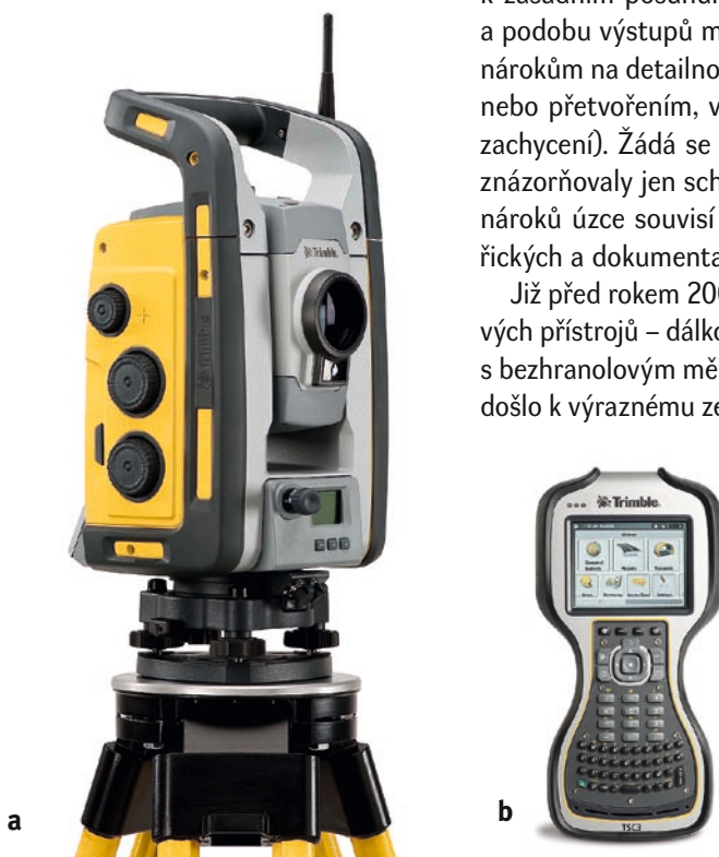
Obr. 4: Ukázka robotizované totální stanice (a), která je na dálku řízena operátorem s kontrolní jednotkou (b). Ilustrační obrázky z www.geotronics.cz
