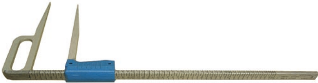
Obr. 39: Velké posuvné měřítko neboli průměrka je velmi praktické při zaměřování krovů a jiných dřevěných konstrukcí, konkrétně pro zjišťování maximálních rozměrů profilů proků, zejména trámů s oblinami (foto J. Veselý, 2014).
