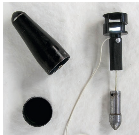
Obr. 41: Vytyčovací dvojitý pentagonální hranol s olovnicí pro vytyčování pravého a přímého úhlu (foto J. Veselý, 2014).
