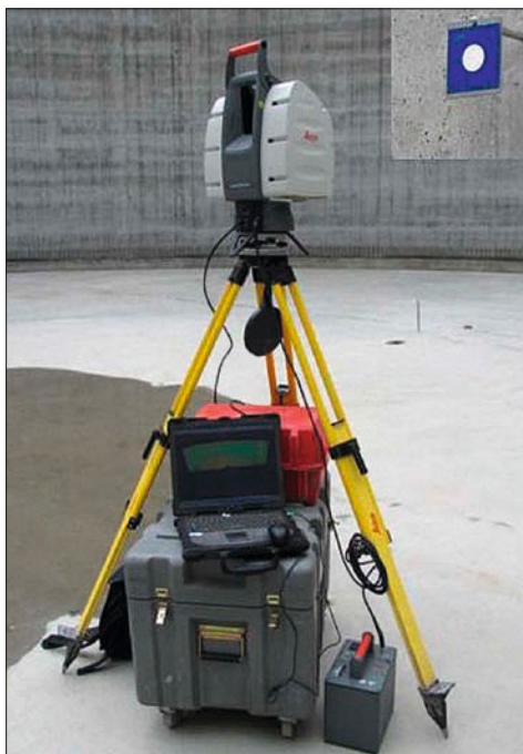
Obr. 34: Statický laserový skener Leica vhodný pro dokumentaci architektury (ilustrační obrázek z www.gefos.cz ).
