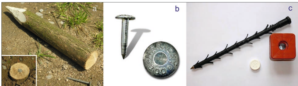
Obr. 12: Stabilizace měřických bodů, typicky vrcholů polygonového pořadu nebo koncových bodů rajónů se provádí podle potřeby řadou způsobů: a – dřevěný kolík s hřebíkem označujícím měřický bod; b – profesionální měřický hřeb; c – stabilnější profesionální plastový mezník (J. Veselý, 2014).
