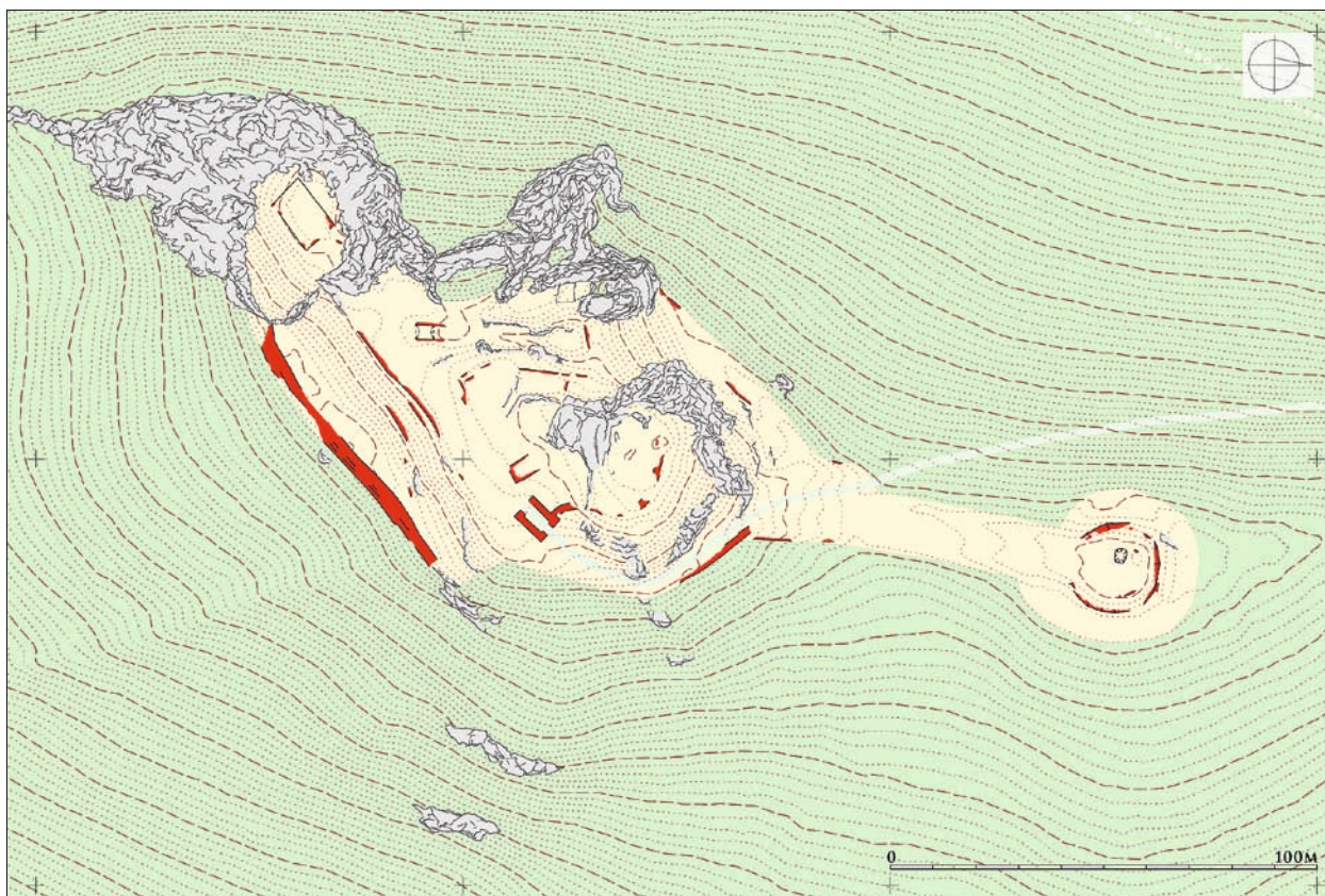
Obr. 76: Vrstevicový plán jádra hradu s intervalem orsteonic po 1 m, získaný metodou leteckého laserového skenování. Všechna zdiava bylo potřeba geodeticky doměřit, práce však trvala pouhé tři dny (hrad Kalich – okres Litoměřice; laserové skenování firma ARGUS GEO SYSTÉM, s. r. o., úprava dat P. Hlavenka a J. Vidman; geodetické měření M. Sýkora, J. Šály; tvorba a úprava plánu P. Hlavenka, M. Sýkora, 2010–2011).
