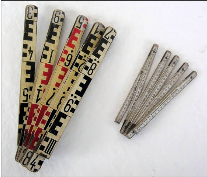
Obr. 37: Tuhá skládací měřidla jsou jedním ze základních nástrojů oměrné metody. Skládací nivelační latě délky 3 m je víceúčelová a s výhodou se používá jako dobře čitelné měřítko na měřických snímcích pro jednoduchou fotogrammetrii (foto J. Veselý, 2014).
