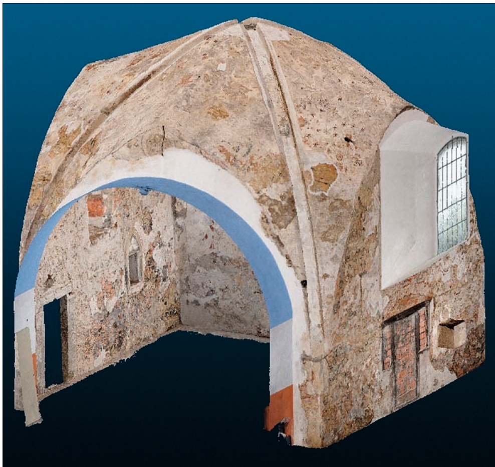
Obr. 9: Mračno bodů – základní výstup 3D skenování slouží pro sestavení texturovaného 3D modelu objektu (Kuřívody – okres Česká Lípa, presbytář kostela sv. Havla; P. Hlavenka, J. Vidman, 2014).
