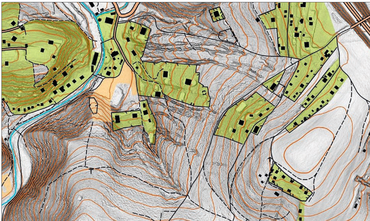
Obr. 10: Digitální model reliéfu terénu s průměrnou přesností kolem 0,2 m ve výšce existuje dnes pro území celé České republiky a je dostupný za poplatek u ČÚZK. Lze jej využít jako podklad zejména při dokumentaci rozsáhlých areálů, hradů, hradišť, zaniklých obcí nebo zámeckých parků. Ilustrační obrázek z internetových stránek www.orientearing.cz (lokality Hláska, Zlenice u Senohrab – okres Praha-východ; koordinace stínované mapy vygenerované na podkladě 4G DMR a státní mapy 1 : 5 000).
